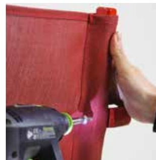
À l'aide d'une visseuse et d'un embout Torx T30, insérez la vis maintenant la toile et le bois de dossier dans l'accoudoir.
