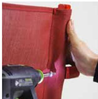
À l'aide d'une visseuse et d'un embout Torx T30, retirez la vis maintenant la toile, le montant du dossier et l'accoudoir ensemble.
